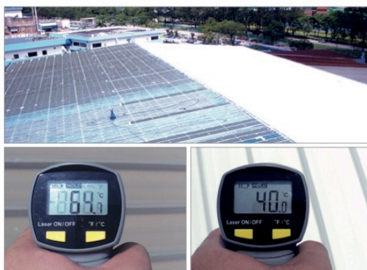
אולם תעשייתי במלזיה. גג האולם מבחוץ (לפני ואחרי): ציפוי הגג הפחית את הטמפרטורה של המשטח ב-24.7 מעלות צ'.
